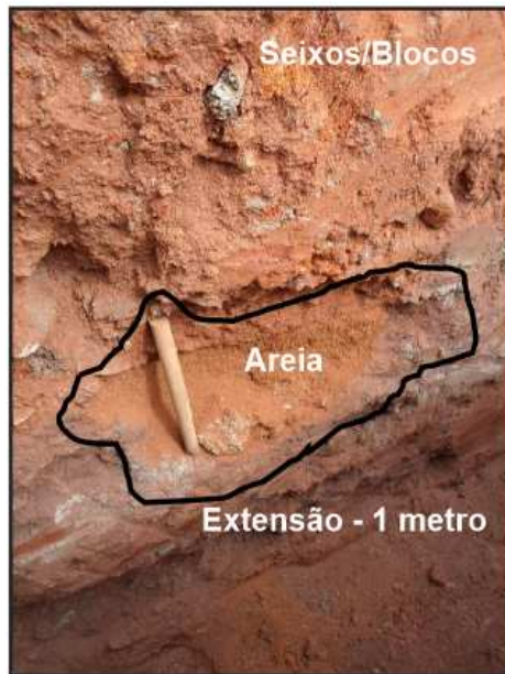
FIGURA 8: Trincheira expondo um bolsão arenoso, com a presença de seixos e blocos de granitóide sobrejacentes imersos em material silto-argiloso.
