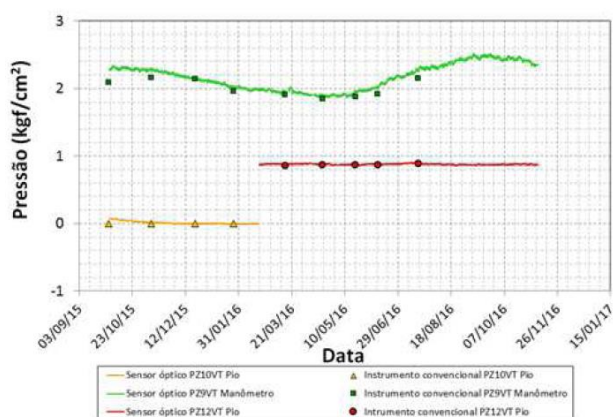
Figura 4. Medidas de três piezômetros localizados no Vertedouro da UHE Foz do Chapecó. (Rosolem, 2017)
