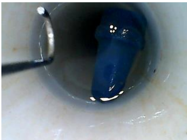
Figura 2. Vista para uma tampa de adesivo plástico no interior do piezômetro. (Neves, 2017)
